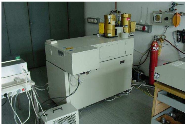
**Abbildung 4.2:** Photographie des Spektrometers Bruker IFS 113v FT-IR. Gut sichtbar sind die goldfarbenen Bolometer auf der Oberseite des Spektrometers.
